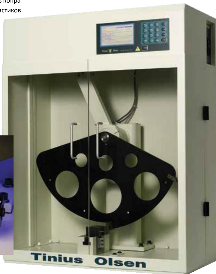
Рисунок 3. Крупный план установки для испытания по Изоду
